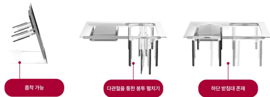
[그림 7] 쓰레기 봉투를 자동으로 잡고 펼쳐주는 구조
